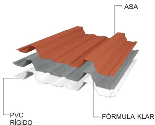
Cada panel cuenta con una capa de PVC rígido (policloruro de vinilo no plastificado) que forma el cuerpo y proporciona estructura, una capa de PVC espumado para generar aislamiento termoacústico y una tercera capa opcional de ASA, un acrílico pigmentado y con textura, adicionalmente contienen agentes de protección UV, estabilizantes. Estos componentes otorgan propiedades de baja inflamabilidad y resistencia a la corrosión por humedad, salitre y una amplia gama de productos químicos.
